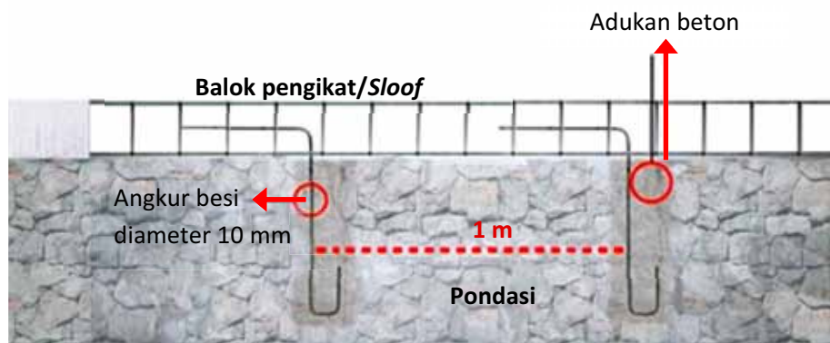
Gambar 43. Hubungan Antara Pondasi dengan Balok Pengikat/ Sloof
