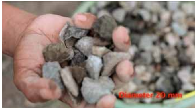
Gambar 5. Diameter Kerikil Yang Baik Untuk Campuran Beton
