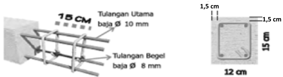
Gambar 21. Dimensi Tulangan Balok Keliling/ Ring
