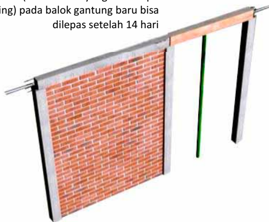
Gambar 61. Pelepasan Cetakan/ Bekisting
