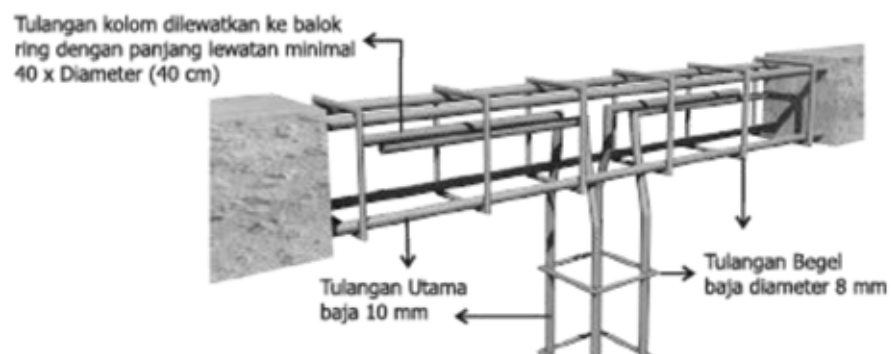
Gambar 48. Hubungan Anatar Kolom dengan Balok Keliling/ Ring
