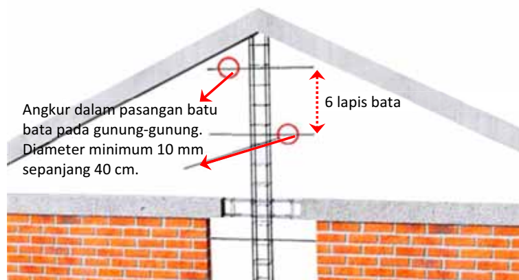
Gambar 52. Hubungan Angkur Pada Gunung-Gunung/ Ampig
