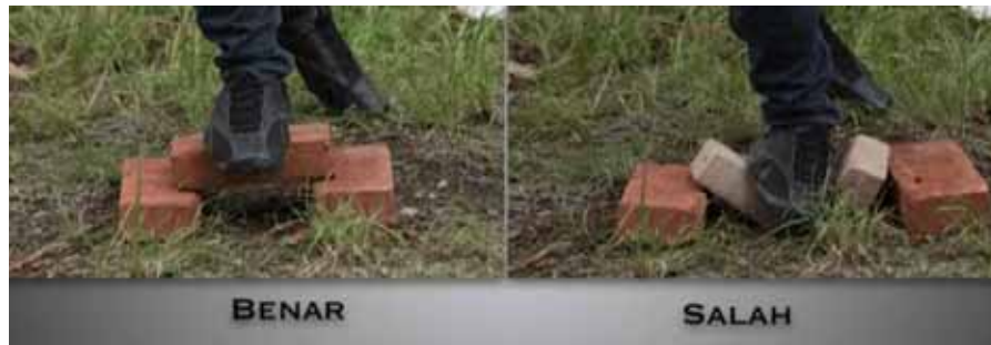
Gambar 13. Pengujian Sederhana Kekuatan Batu Bata
